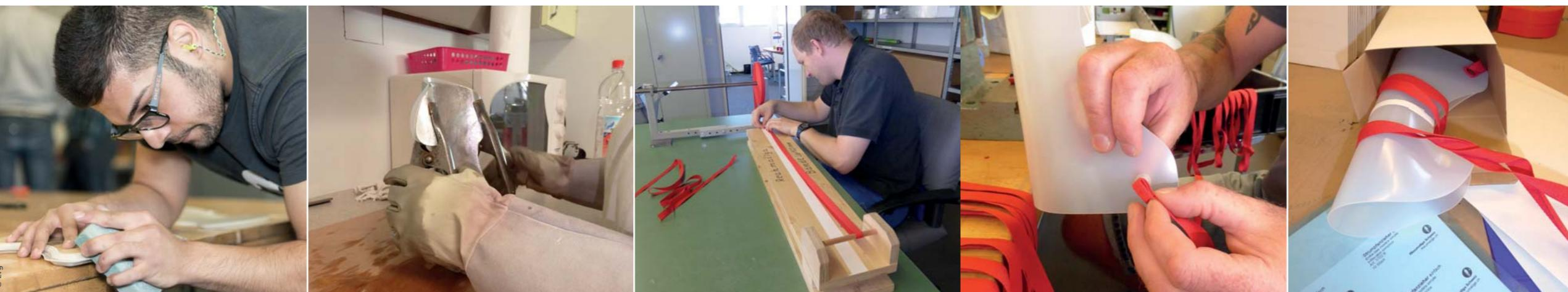
**Kanten schleifen.** Der angelieferte Kunststoff weist rauhe Kanten auf. Eine speziell dafür kreierte Vorlage verhindert, dass die Strumpfführung zerkratzt wird.
