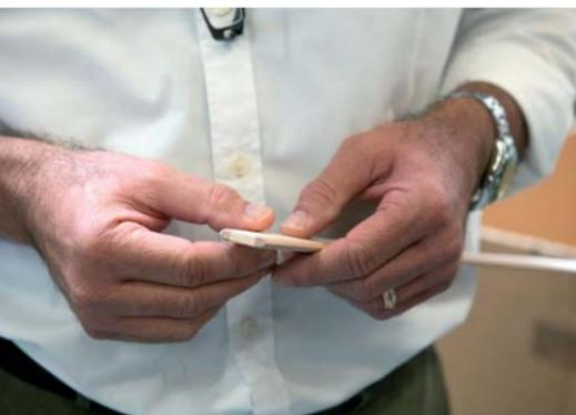
Die Lättli bestehen aus drei Massivholzstreifen. Die vertikale Verleimung ermöglicht einen Abtransport der Feuchtigkeit, die durch das nächtliche Schwitzen entsteht.
